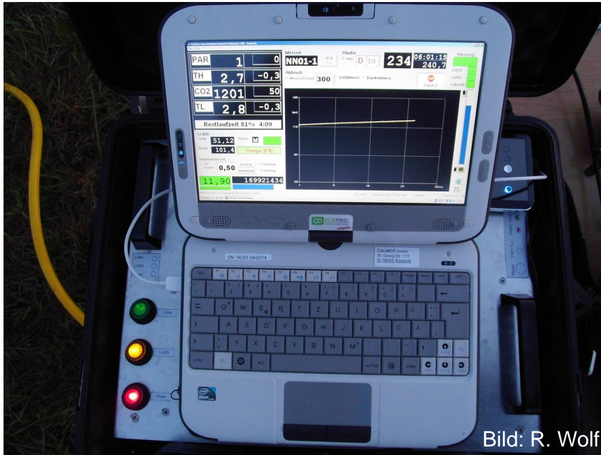
Abb. 15: Laptop-Bildschirm während einer Dunkelmessung mit Licor-Infrarot-Analyzer.
