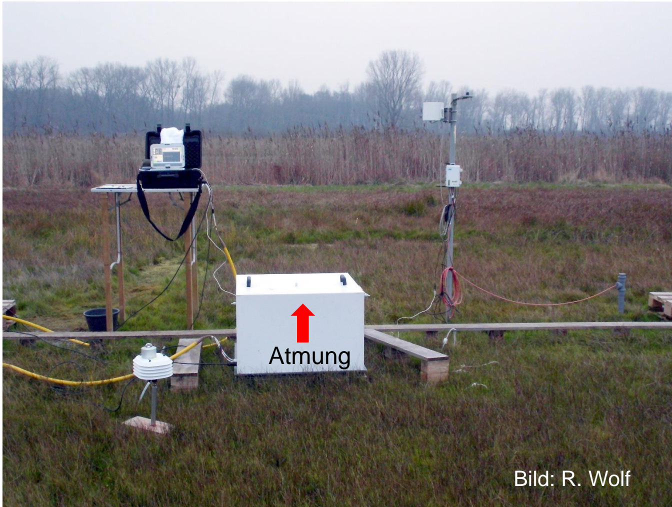
Abb. 13 : Bestandteile beim Messen von CO 2 : Dunkel-Haube mit Schlauch und CO 2 -Analyser im Koffer, Pyranometer und Wetterstation
